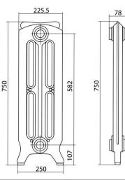
Чугунные радиаторы FLOREAL CHAPPEE (Франция) - достойный образец классического "дворцового" стиля. Радиаторы предназначены для эксплуатации в закрытых системах отопления. Радиаторы FLOREAL поставляются с 2-я отверстиями на " (вход / выход), одно отверстие на 1/8" под Кран Маевского (воздуховыпускной клапан) и 1-й заглушкой. Для подключения прибора в систему предлагается использовать комплекты Carli Poletti состоящие из:
